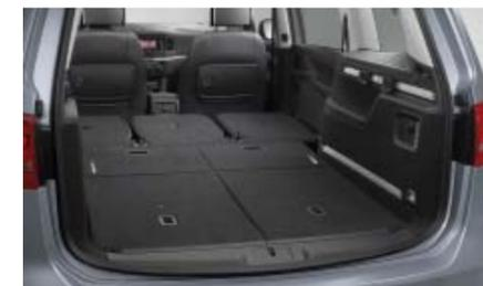
Eine Erweiterung der Durchlademöglich- keit bietet die komplett **umklappbare Beifahrersitzlehne**. Die ebene Fläche ist zudem als Tisch verwendbar. |so|c|H Der gut zugängliche und dank „EasyFold“ ebenso **variable Gepäckraum** wartet je nach Anordnung der Sitze selbst als optionaler 7-Sitzer mit einem großzügigen Ladevolumen von 300 bis 2.297 Litern auf. Die optional erhältliche Gepäckraum- klappe mit Umfeldbeleuchtung sorgt für zusätzlichen Komfort. |s
