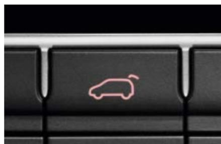
Die elektrische Gepäckraumklappe lässt sich vom Fahrersitz aus oder mit dem Funkschlüssel mühelos öffnen. Sie schließt sich nach Betätigung eines Tasters in der Klappe selbstständig. |so
