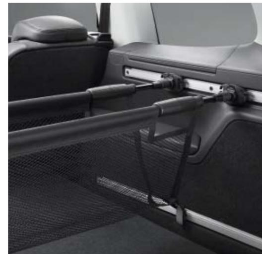
Zum praktischen „Cargo-Paket“ gehört eine Netztrennwand, die Ihr Gepäck vom Fahrgastraum trennt. Zudem bleibt mit den beiden dazugehörigen Verzurr- bändern, einer Halteöse, zwei seitlichen Schienen sowie einem Kuvertnetz mit Taschenfunktion auch beim Bremsen alles an seinem Platz. |so
