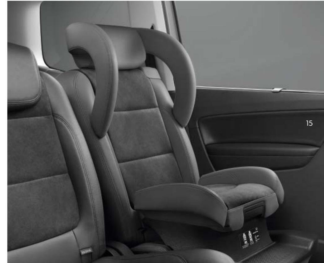
↑ Die zweite Sitzreihe kann wahlweise mit **einem oder zwei praktischen integ- rierten Kindersitzen** ausgestattet werden. Kindern zwischen 15 und 36 Kilogramm bietet die einfach montierbare Seiten- kopfstütze zusätzlichen Schutz für den Kopf und die Halswirbelsäule. Selbst- verständlich entsprechen alle Kindersitze von Volkswagen hohen Sicherheits- standards. |so
