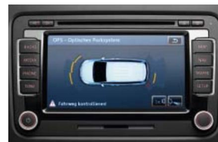
Der ParkPilot mit Sensoren im vorderen und hinteren Stoßfänger warnt Sie beim Einparken – im Rahmen der Grenzen des Systems – mit akustischen Signalen vor Hindernissen: Je näher Sie einem Widerstand kommen, umso schneller wird die Tonfrequenz. |so
