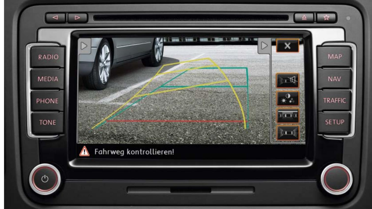
Auf dem Radiodisplay wird das im eingeschränkten Sichtbereich der Rückfahrkamera „Rear View“<sup>3)</sup> erzeugte Bild wiedergegeben. Die freie Sicht hinter das Fahrzeug ermöglicht so einfacheres Einparken. Aufgrund der detaillierten Darstellung können selbst kleine Hindernisse wie Stufen erkannt werden. |so
