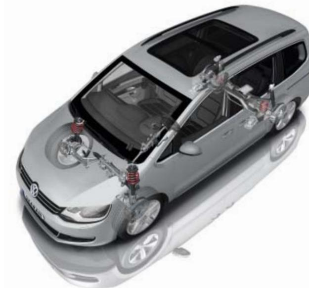
← Die **adaptive Fahrwerksregelung DCC** stellt innerhalb von Millisekunden jeden Dämpfer individuell auf die Fahrbahn und die Fahr situation ein. Per Knopfdruck haben Sie dabei die Wahl zwischen den drei Varianten **COMFORT**, **NORMAL** und **SPORT**. |so
