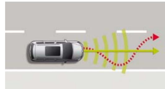
Der Spurhalteassistent „Lane Assist“ kann – im Rahmen der Grenzen des Systems – die Aufmerksamkeit des Fahrers mit einem korrigierenden Lenkeingriff wieder auf das Fahrgeschehen lenken, wenn das Fahrzeug droht, unbeabsichtigt die Spur zu verlassen. |so
