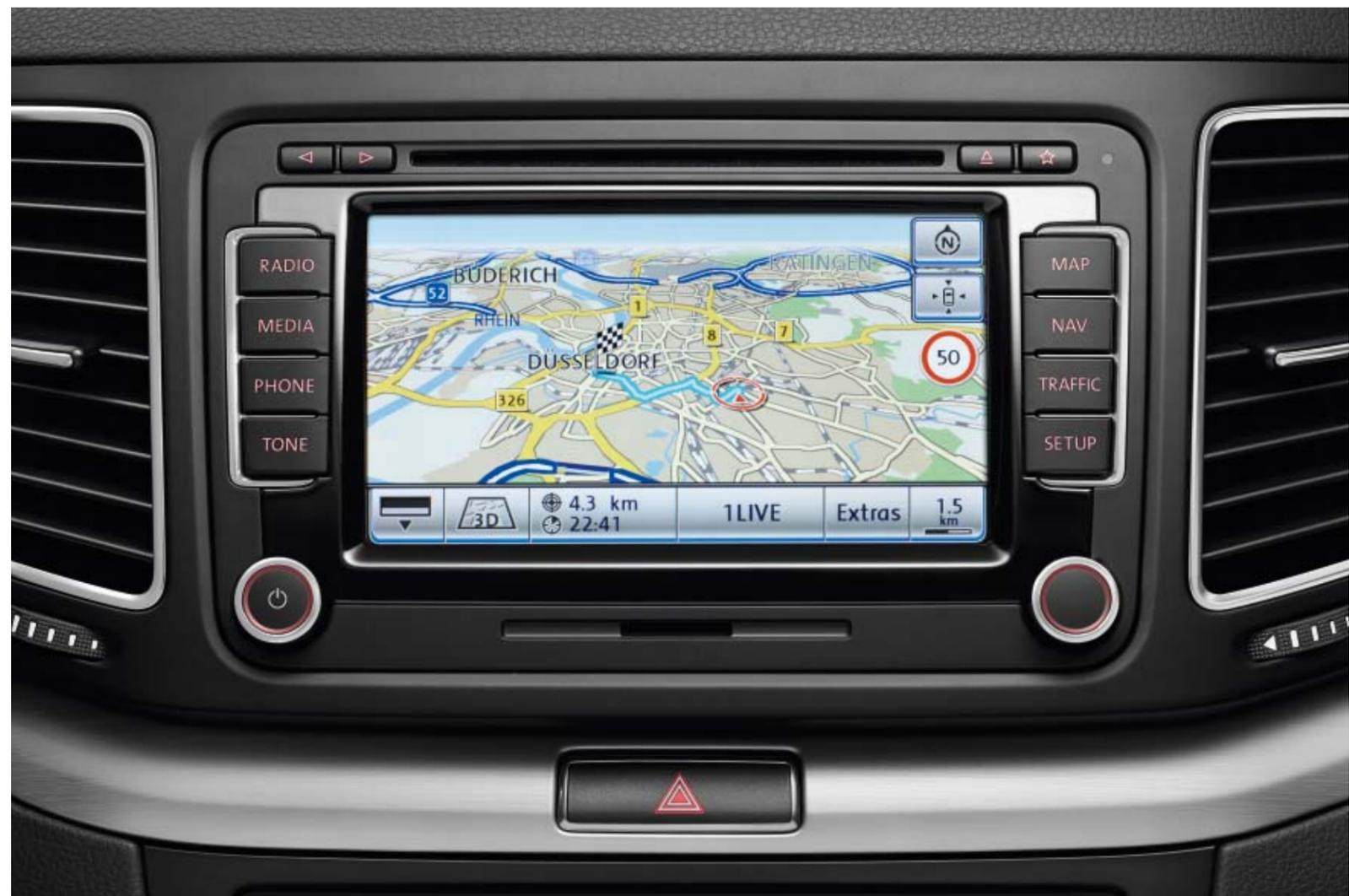
Das Radio-Navigationssystem „RNS 510“ mit Sprachbedienung, Picture Navigation, Touchscreen, großem Farbdisplay, DVD-Laufwerk, 30-Gigabyte-Festplatte, SD-Kartenschacht, AUX-IN-Buchse und Verkehrszeichenanzeige ist mit vorinstallierten Europakarten ausgestattet. |so
