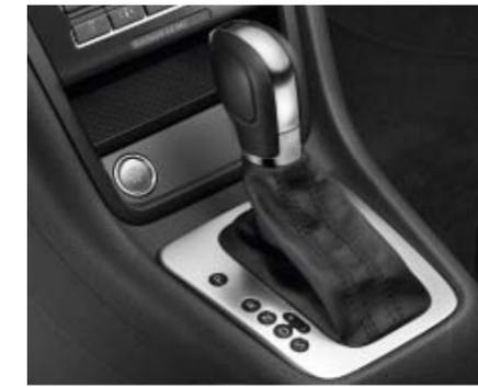
Ein Meilenstein in der Entwicklung des Getriebebaus: das **Doppelkupplungsgetriebe DSG<sup>1)</sup>**. Dieses innovative Getriebe wechselt automatisch in wenigen Hundertstelsekunden nahezu unmerklich und ohne Zugkraftunterbrechung in den bereits vorgewählten nächsten Gang. |so
