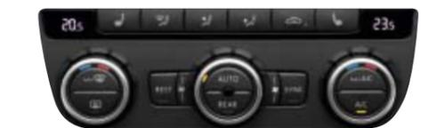
Die Klimaanlage „Climatronic“ mit Anti-beschlagsensor zur effizienteren Nutzung der Klimaanlage verfügt über eine getrennte 3-Zonen-Temperaturregelung mit Luftausströmern für Fahrer, Beifahrer und Passagiere im hinteren Bereich. |so
