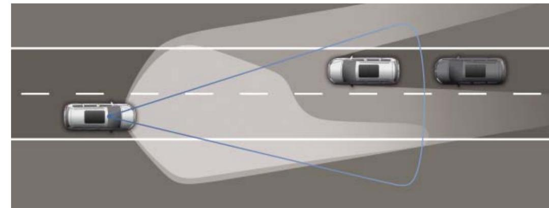
↑ Die Fernlichtregulierung „Light Assist“ kann mit einer hinter der Frontscheibe verbauten Kamera entgegenkommende und vorausfahrende Kraftfahrzeuge erkennen und schaltet automatisch zwischen Abblend- und Fernlicht um. Durch dieses intelligente System wird nicht nur der Fahrer entlastet, sondern auch die Einschaltzeit des Fernlichts deutlich erhöht und damit eine verbesserte Sicht ermöglicht. Mehr Komfort und Sicherheit auf Nachtfahrten sind das Ergebnis. |so
