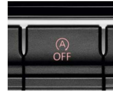
Das **Start-Stopp-System<sup>2)</sup>** steht für sparsames und schadstoffarmes Fahren. Beim Halten im Stau oder an einer Ampel reicht es, die Kupplung zu lösen und den Gang herauszunehmen bzw. die Bremse zu treten (bei Doppelkupplungsgetriebe DSG), und der Motor schaltet sich aus. |s
