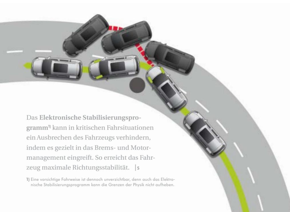
Das Elektronische Stabilisierungsprogramm<sup>1)</sup> kann in kritischen Fahrsituationen ein Ausbrechen des Fahrzeugs verhindern, indem es gezielt in das Brems- und Motormanagement eingreift. So erreicht das Fahrzeug maximale Richtungsstabilität. |s
