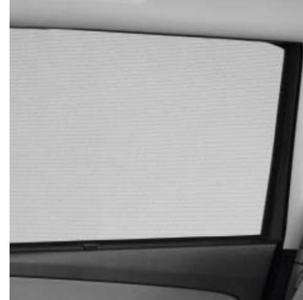
Vor übermäßiger Erwärmung des Innenraums und direkter Sonneneinstrahlung im hinteren Bereich schützt der **Sonnenschutz** für die hinteren Seitenfenster, Kofferraumscheiben und die Heckscheibe. Und das, ohne die Sicht nach hinten und damit die Verkehrssicherheit zu beeinträchtigen. |so
