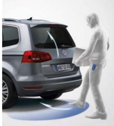
Mit der Komfortfunktion „Easy Open“<sup>2)</sup> lässt sich die Gepäckraumklappe Ihres Sharan öffnen, auch wenn Sie einmal keine Hand frei haben. Das System erkennt den Schlüssel des Schließ- und Startsystems „Keyless Access“ und öffnet den Gepäckraum, sobald Sie mit einer kurzen Fußbewegung den Sensor am Heck auslösen. |so
