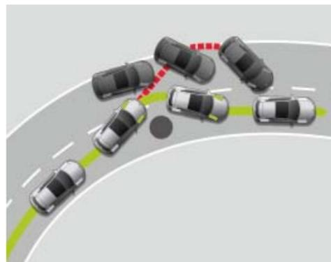
Das **Elektronische Stabilisierungsprogramm** kann in kritischen Fahrsituationen ein Ausbrechen des Fahrzeugs verhindern, indem es gezielt in das Brems- und Motormanagement eingreift. So erreicht das Fahrzeug maximale Richtungsstabilität.\* Das System kann bei Bedarf auch abgeschaltet werden. | **S**
