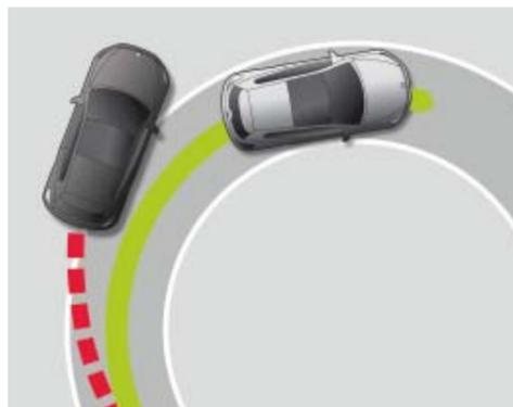
Die **elektronische Differentialsperre XDS inkl. Berganfahrassistent** ist eine Erweiterung des Elektronischen Stabilisierungsprogramms. In Kurven wird das Handling wirkungsvoll verbessert und die Neigung zum Untersteuern vermindert – für mehr Sicherheit und Dynamik. | **SO**
