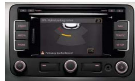
Der **„ParkPilot“** warnt im Rahmen der Grenzen des Systems beim Einparken mit akustischen Signalen vor Hindernissen vorn und hinten: Je näher Sie einem Widerstand kommen, desto schneller wird die Tonfrequenz. In Kombination mit dem Radio „RCD 310“ bzw. „RCD 510“ oder dem Radio-Navigationssystem „RNS 315“ bzw. „RNS 510“ informiert Sie der **„ParkPilot“** in einer **Anzeige auf dem Display** auch optisch über Abstände zu Hindernissen. | **SO**
