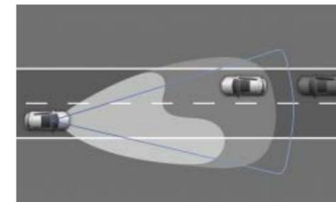
Die **Fernlichtregulierung „Light Assist“** kann mit einer hinter der Frontscheibe verbauten Kamera entgegenkommende und vorausfahrende Kraftfahrzeuge erkennen und schaltet automatisch zwischen Abblend- und Fernlicht um. Durch dieses intelligente System wird nicht nur der Fahrer entlastet, sondern auch die Einschaltzeit des Fernlichts deutlich erhöht und damit eine verbesserte Sicht ermöglicht. Mehr Komfort und Sicherheit auf Nachtfahrten sind das Ergebnis. | **SO**
