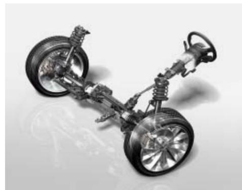
Die **McPherson-Vorderachse** hat dank der Verwendung hochfester Materialien ein besonders niedriges Gewicht und braucht nur wenig Platz. In der Fahrpraxis bedeutet das: Der Fahrer profitiert von gutem Fahrkomfort und hoher Fahrsicherheit. | **S**
