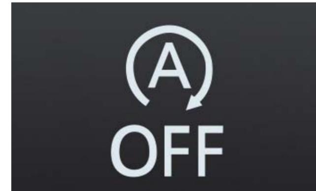
Das **Start-Stopp-System** steht für sparsames und schadstoffarmes Fahren. Beim Halten im Stau oder an einer Ampel reicht es, die Kupplung zu lösen und den Gang herauszunehmen, und der Motor schaltet sich aus. Zum Weiterfahren kuppeln Sie einfach wieder ein. | **SO**
