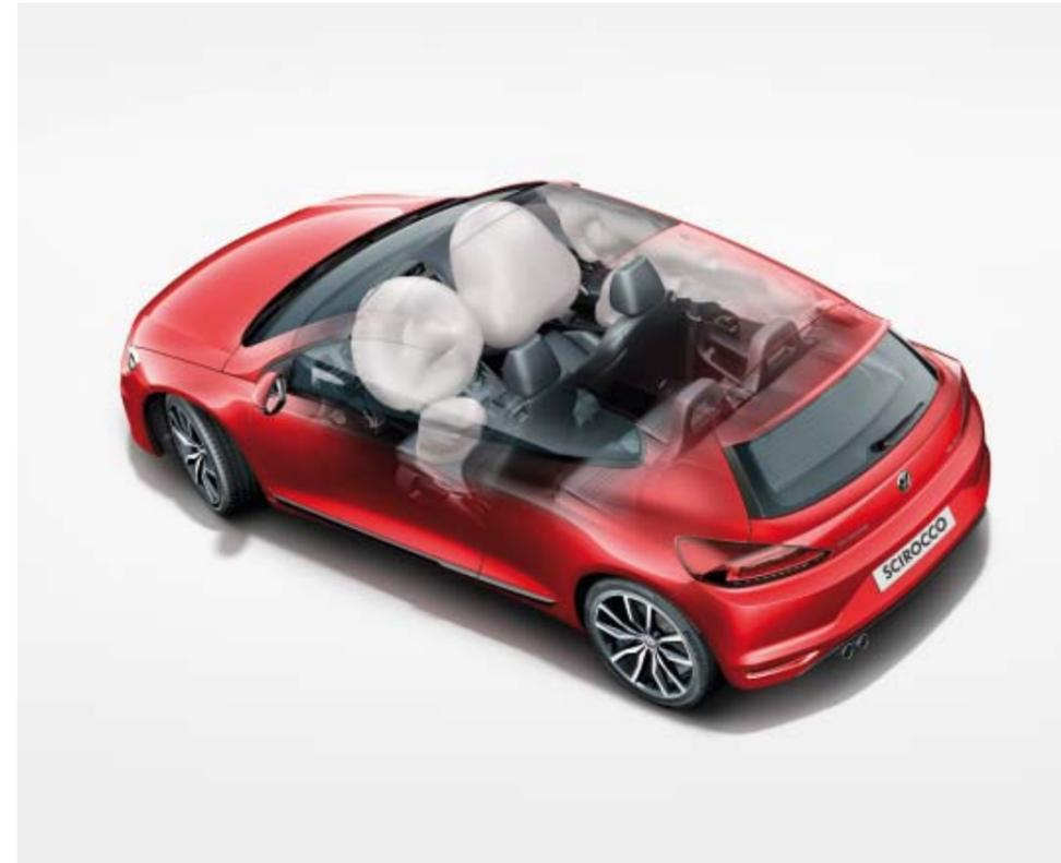
Die Passagiere des Scirocco können sich im Ernstfall auf das **Airbagsystem** verlassen. Es beinhaltet Airbags für Fahrer und Beifahrer mit Beifahrerairbag-Deaktivierung, ein Kopfairbagsystem für die Passagiere beider Sitzreihen sowie Seitenairbags vorn. Die Auslösung der Airbags erfolgt mittels sogenannter Crashesensoren: Wird ein Aufprall registriert, zündet das Airbagsteuergerät den Gasgenerator, der die Airbags innerhalb von 30 bis 40 Millisekunden füllt. | **S**
