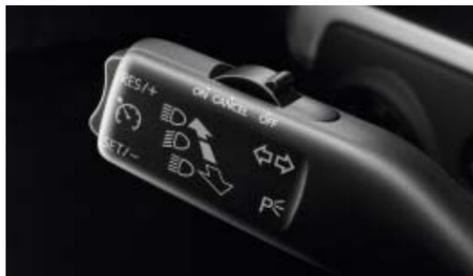
Die **Geschwindigkeitsregelanlage** hält ab 30 km/h das von Ihnen gewählte Tempo selbstständig und trägt auf diese Weise vor allem auf längeren Strecken zum entspannten Fahren bei. | **SO**
