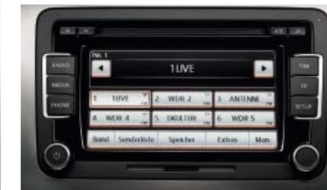
Das **Radio „RCD 510“** mit großem Farbdisplay, Titelanzeige, Touchscreen, SD-Kartenschacht, AUX-IN-Buchse, 6-fach-CD-Wechsler und 4x 20 Watt Leistung mit Lautsprechern vorn und hinten ist MP3- und WMA-fähig und verfügt über eine 3-fach-Klangregelung. | **SO**
