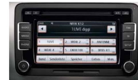
Mit dem **digitalen Radioempfang** Digital Audio Broadcasting DAB+ können Sie zusätzlich zum analogen Senderangebot digital ausgestrahlte Radiosender empfangen. | **SO**
