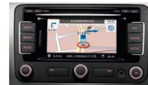
Das **Radio-Navigationssystem „RNS 315“** mit Farbdisplay, CD-Laufwerk und Kartennavigation via Touchscreen ist MP3-fähig und mit Verkehrszeichenanzeige, dynamischer Zielführung (TMC), AUX-IN-Buchse, SD-Kartenschacht und vorinstallierten Europakarten ausgestattet. | **SO**
