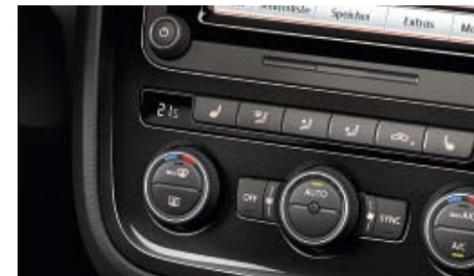
Wie die serienmäßige Klimaanlage sorgt auch die **Klimaanlage „Climatronic“** für eine angenehme Innenraumtemperatur. Zusätzlich teilt sie den Innenraum in zwei Klimazonen für Fahrer- und Beifahrerseite. Temperatur, Luftzufuhr und -verteilung können individuell eingestellt werden. | **SO**
