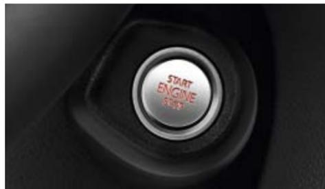
Für höchsten Komfort steht das **schlüssellose Schließ- und Startsystem „Keyless Access“**. Eine ausgeklügelte Funk- und Sicherheitstechnik ermöglicht das Öffnen und Schließen ohne aktive Nutzung des Schlüssels. Das Starten und Abstellen des Motors erfolgt per Knopfdruck. | **SO**
