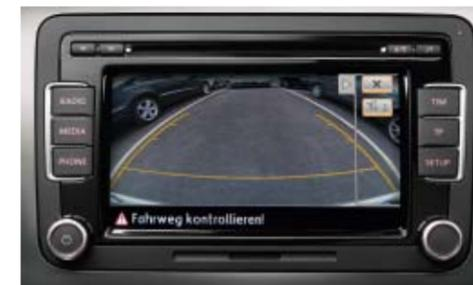
Zusätzlich zu akustischen Signalen wird auf dem Radiodisplay das Bild der **Rückfahrkamera** **„Rear View“** realitätsgetreu wiedergegeben. Die freie Sicht hinter das Fahrzeug ermöglicht ein einfacheres Einparken im Rahmen der Grenzen des Systems. Aufgrund der hochauflösenden und detaillierten Darstellung können selbst kleine Hindernisse wie etwa Bordsteinkanten deutlich erkannt werden. | **SO**
