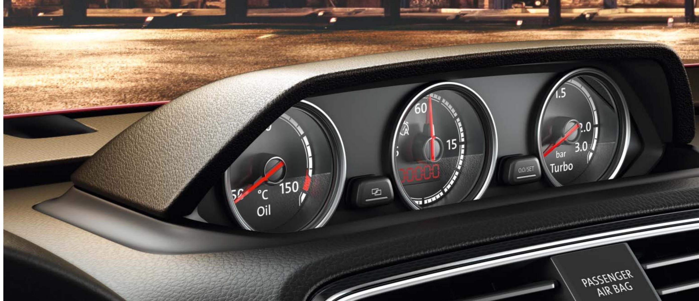
Mit dem neuen **Zusatzinstrument auf der Schalttafel** haben Sie die Öltemperatur sowie den Druck des Turboladers immer im Blick. Außerdem verfügt es über eine multifunktionale Stoppuhr, die Stand- und Fahrzeiten messen kann. | **SO**
