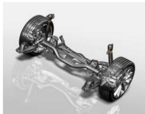
Eine Mehrlenkerachse wie die **Vierlenker-Hinterachse** im Scirocco ist vor allem für die Fahrdynamik von Vorteil, denn sie kann optimal auf die äußeren Gegebenheiten abgestimmt werden. | **S**
