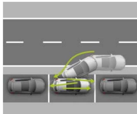
Der Parklenkassistent **„Park Assist“** kann im Rahmen der Grenzen des Systems Quer- und Längsparklücken erkennen und selbstständig einlenken, während der Fahrer nur Kupplung, Gas und Bremse betätigt. | **SO**
