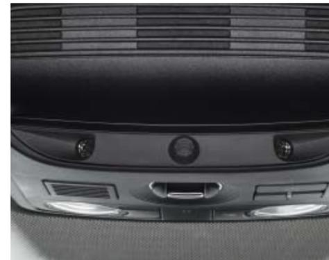
Die **Diebstahlwarnanlage „Plus“** verfügt im Innenleuchtenmodul des Dachhimmels über eine Innenraumüberwachung. Inklusive elektronischer Wegfahrsperrung und Abschleppschutz. | **SO**
