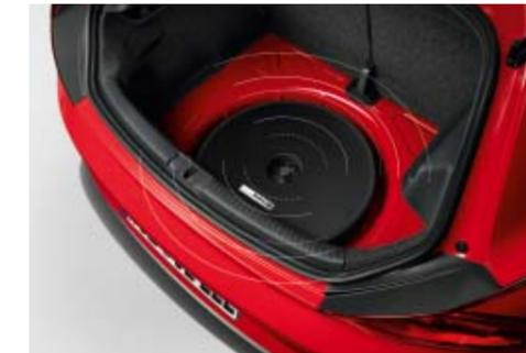
Das **Plug & Play Soundsystem** passt perfekt in die Reserveradmulde Ihres Scirocco und macht den Kofferraum zum Klangkörper. Das System besteht aus einem Verstärker mit integriertem Digital Sound Processor und einem leistungsstarken Subwoofer. Mit einer Ausgangsleistung von bis zu 480 Watt bietet es satten Sound und Musikgenuss auf höchstem Niveau. | SO
