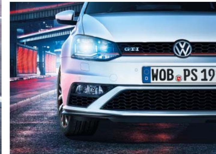
Beim näheren Betrachten fallen weitere Highlights auf. Zum Beispiel die neuen **Scheinwerfer mit roter Tornadolinie**, die sich durch die ganze Front zieht. Sowie die optionalen **LED-Leuchten**: Sie erzeugen eine tageslichtähnlichere Farbe als Xenon-Licht und sind vor allem energieeffizient. Außerdem verfügt der neue Polo GTI über **Nebelscheinwerfer** und sportliche **Stoßfänger** mit Splitter rechts und links. **S**
